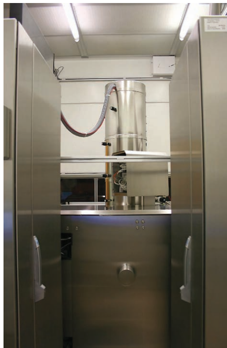
Abb 1: 50 keV-Elektronensäule (links) und Beladestation (rechts) der SB350 OS.
